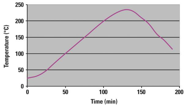
**倒装芯片助焊剂NC-26-A**应使用氧气含量低于100ppm的氮气气氛进行回流。尽管取得最佳结果仍需惰性气氛，某些应用可采用空气气氛。**倒装芯片助焊剂NC-26-A**可在多种表面上使用，包括浸银、铜和AuNi。这些表面可用SnPb或者无铅合金进行焊接，然而当温度超过240°C以后需要使用氮气气氛。
