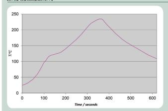
倒装芯片助焊剂NC-26S应使用氧气含量低于100ppm的氮气气氛进行回流。尽管取得最佳结果仍需惰性气氛,某些应用可采用空气气氛。倒装芯片助焊剂NC-26S可在多种表面上使用,包括浸银、铜和AuNi。这些表面可用SnPb或者无铅合金进行焊接,然而当温度超过240°C以后需要使用氮气气氛。
