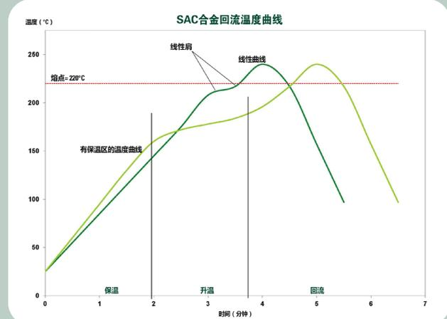
表中推荐的曲线适用于大多数SnAgCu（SAC）的无铅合金，包括SAC305（96.5%锡/3%银/0.5%铜）。使用Indium8.9HF时，上表可作为确定回流曲线的一般性参考。根据特定的工艺要求（包括基板大小、厚度和密度），对曲线做出改动是可行的，也可能是必要的。线性曲线中的水平保温区间（线性波峰）也可以被移除。
