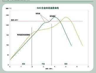
表中推荐的曲线适用于大多数SnAgCu(SAC)的无铅合金,包括SAC305 (96.5%锡/3%银/0.5%铜)。使用Indium8.9HFZ时,上表可作为确定回流曲线的一般性参考。根据特定的工艺要求(包括基板大小、厚度和密度),对曲线做出改动是可行的,也可能是必要的。线性曲线中的水平保温区间(线性波峰)也可以被移除。
